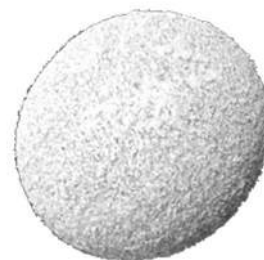
Шар после 12 часов в электролите при t=80°C
